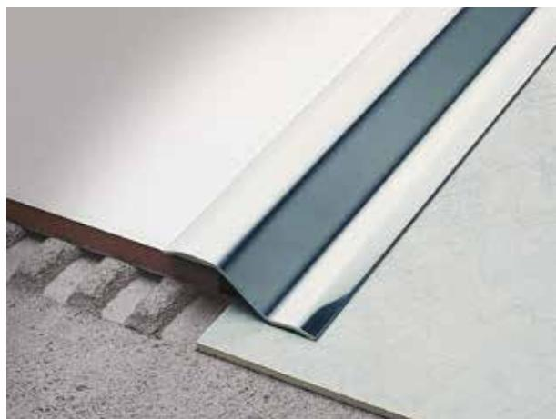
VARIOTEC DK sono profili di raccordo tra pavimenti già posati di diversa natura e livello. Compensano spessori compresi tra 7 e 16 mm. Autoadesivi: sono forniti di un particolare elastomero che ne consente una facile e rapida applicazione. Per l'installazione sarà sufficiente rimuovere la carta protettiva dell'adesivo e applicare il profilo, tagliato alla lunghezza richiesta, con pressione uniforme. Per una buona tenuta la superficie di supporto deve essere liscia, pulita, asciutta e sgrassata.
